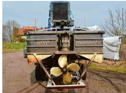
Mit dieser mächtigen Schraube wirbelt „Big Foot“ das Sediment auf Alfred Schley
